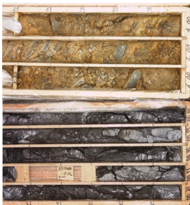
図8 岩盤クリープを示すコア
