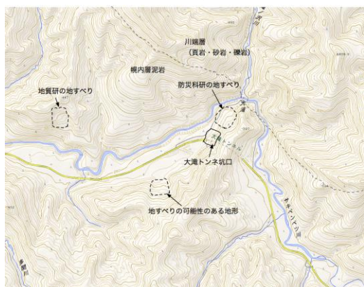
図 3 道々135号大滝トンネル周辺の地すべり
